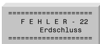
! Eine der 3 Motorleitungen hat Verbindung zu Erde.
