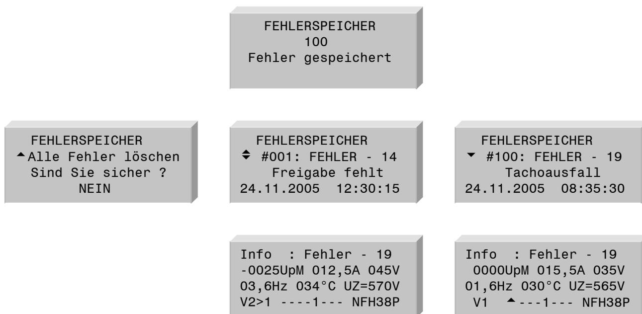
Durch Drücken der ENTER-Taste können Sie zu jedem gespeicherten Fehler weiter Informationen abrufen. Diese können zur weiteren Fehleranalyse und -behebung herangezogen werden und werden im Folgenden beschrieben:
