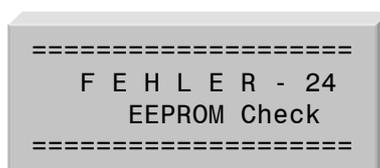
! Die Regel und Bedienerparameter wurden falsch aus dem EEPROM ausgelesen.
